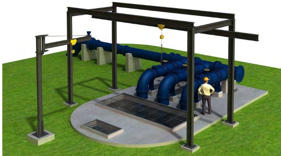
ESTAÇÃO ELEVATÓRIA BAIXA CARGA
