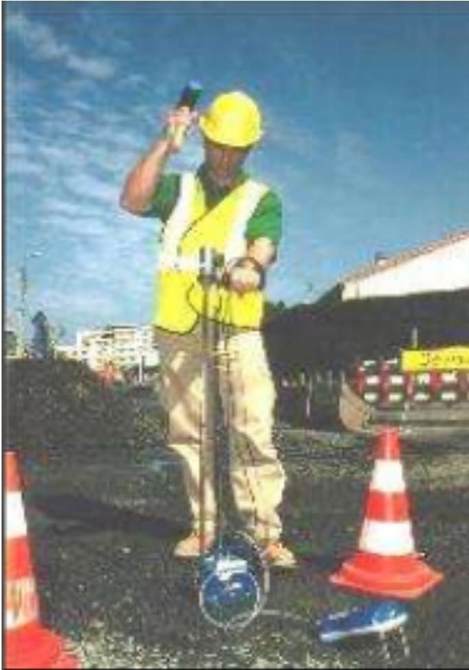
*O ensaio consiste em penetrar, por meio de golpes manuais (martelo), uma série de barras com uma ponteira e medir a resistência do solo até a profundidade desejada*
