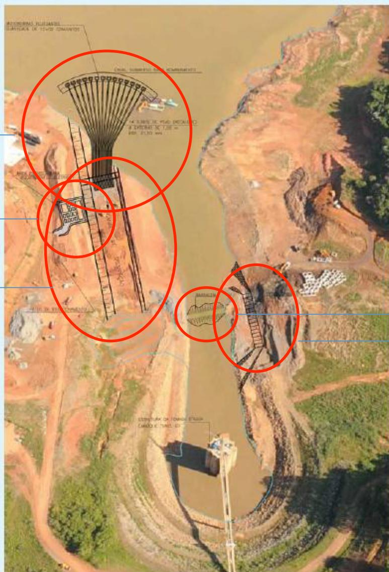
**14 Conjunto de bombas** fixadas em flutuadores, com linha de recalque, somando uma vazão máxima de 28 m<sup>3</sup>/s, elevando o volume armazenado até canal de dissipação de energia hidráulica.
