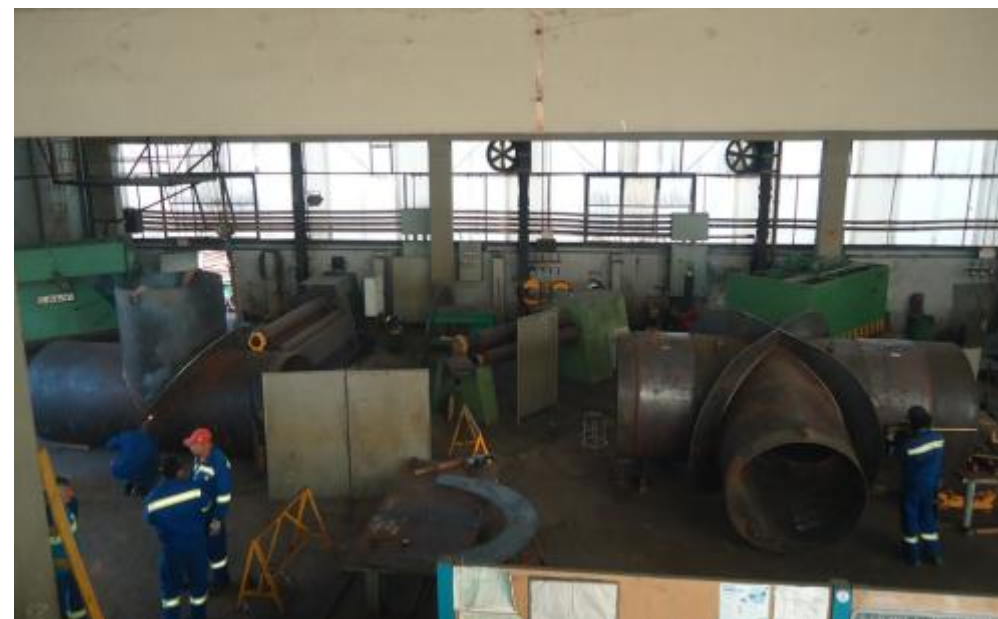
Parte superior da chaminé de equilíbrio – Tubulação com 12m de comprimento
