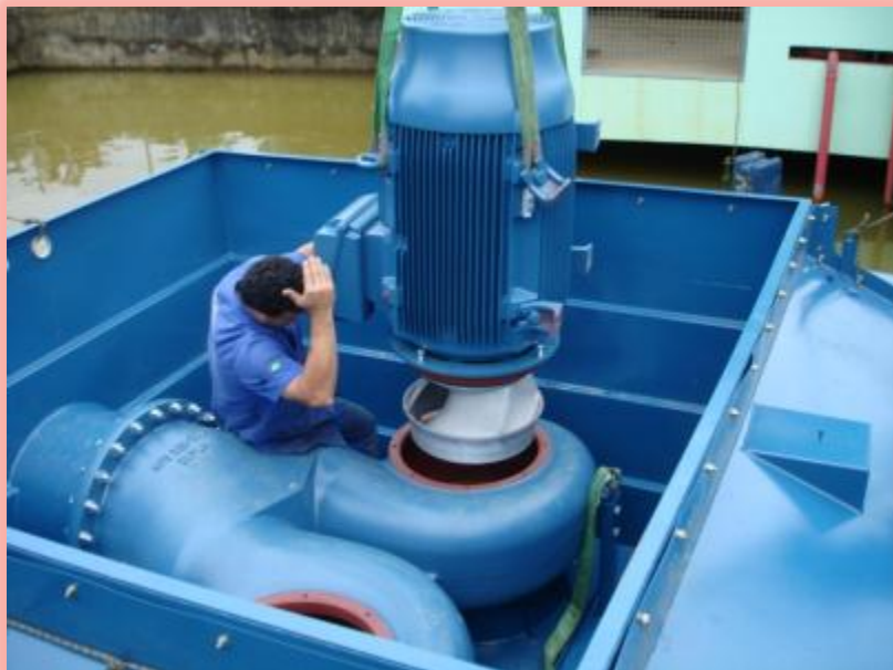
Parte interna da motobomba flutuante
