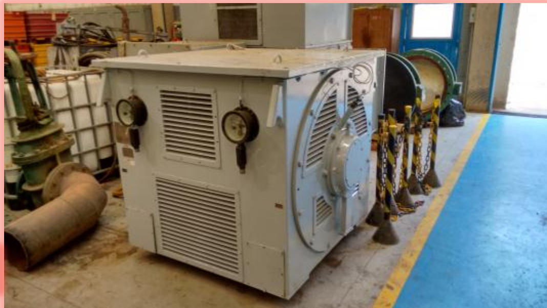
Motor elétrico Toshiba 1250 cv
