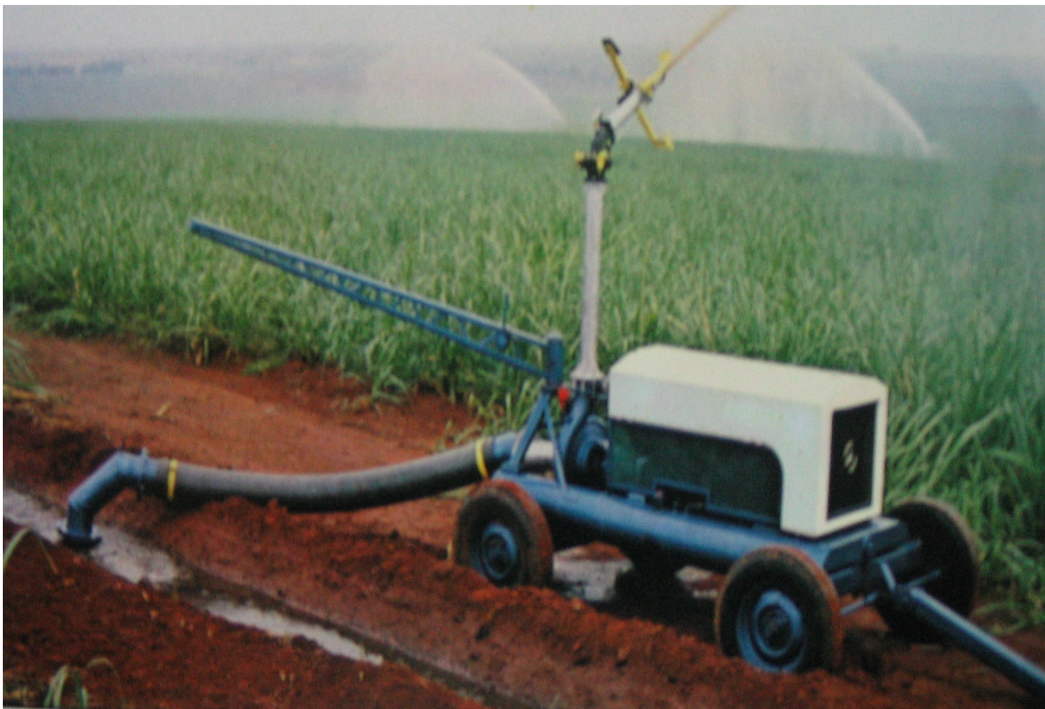
Fig. Montagem Direta (irrigação por aspersão mecanizada)
