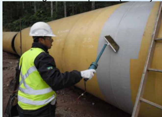
Ensaio de integridade da pintura (Holliday Detector)
