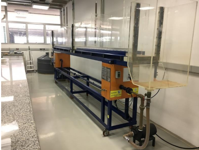
Estudos hidráulicos de canais e aulas experimentais para a Engenharia Ambiental e Urbana
