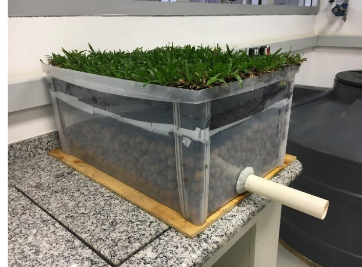
Ensaio experimental de tecnologias de drenagem sustentável – jardins de chuva
