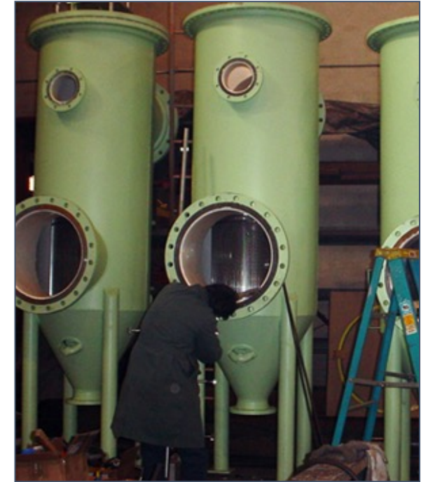
Filtros raspadores projetados para Codelco (maior mineração de cobre do mundo). Localização : Chile
