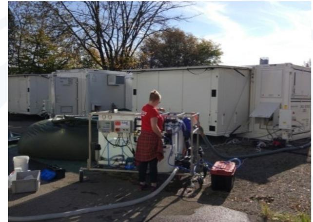
Sob um contrato com a MSF, segue uma unidade móvel flexível e implantável em todas as situações extremas, quente e fria. A instalação de água destina-se a fornecer água potável para um hospital móvel realizando cirurgias de guerra em zonas de conflito ao redor do mundo e em todas as condições climáticas. @sotrad.
