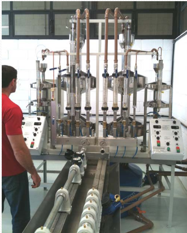
Fotografia 1: Bancada de aferição de hidrômetros (DN \frac{3}{4} " e DN 1").
