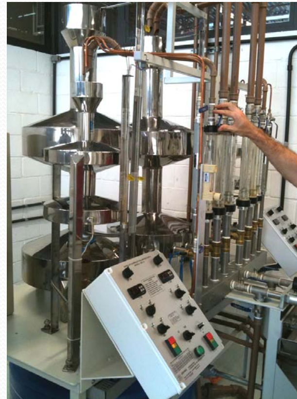
Fotografia 2: Bancada de aferição de hidrômetros (DN \frac{3}{4} " e DN 1").
