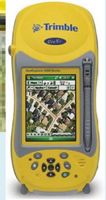
Equipamentos móveis com câmera fotográfica e GNSS integrados
