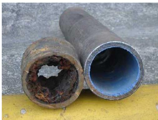
**Figura 10: Comparação do estado estrutural da rede, antes e depois dos serviços.**
