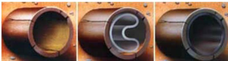
**Figura 6: Inserção por Compact Pipe ou U-Liner.**
