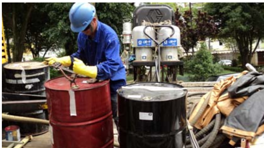
Figura 14 - Equipamento que faz a mistura da tinta e catalisador
