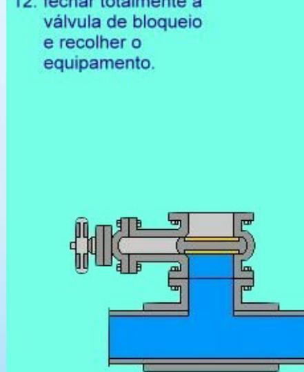
Sequência de atuação do dispositivo de bloqueio em carga
