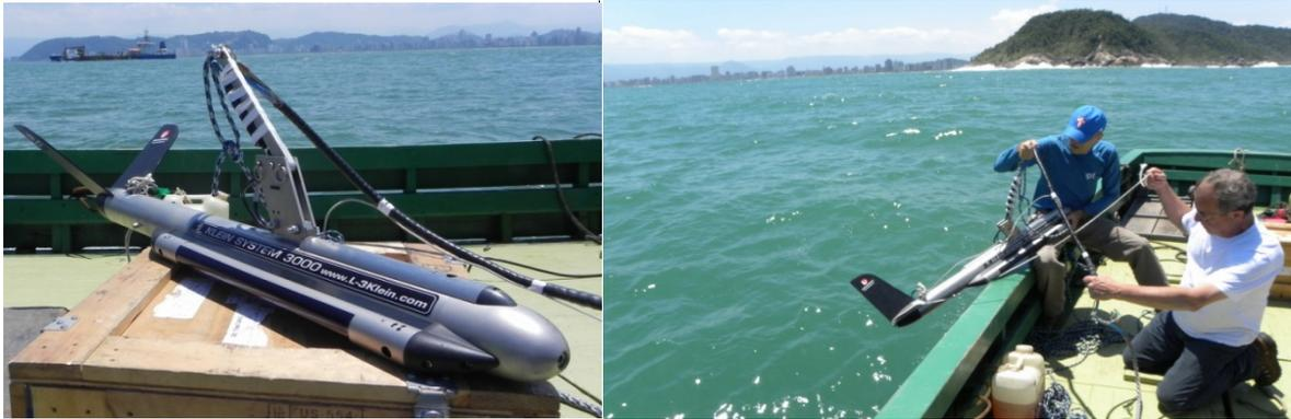
**Figura 6: Sonar de Varredura Lateral Klein (pertencente ao IPT) em operação na Praia Grande, litoral de São Paulo, Brasil; a) foto à esquerda, a fonte acústica de dupla frequência (100/500 kHz) denominada de “peixe”; b) foto à direita, equipe do IPT em operação de lançamento do peixe (ao fundo, a cidade de Praia Grande).**
