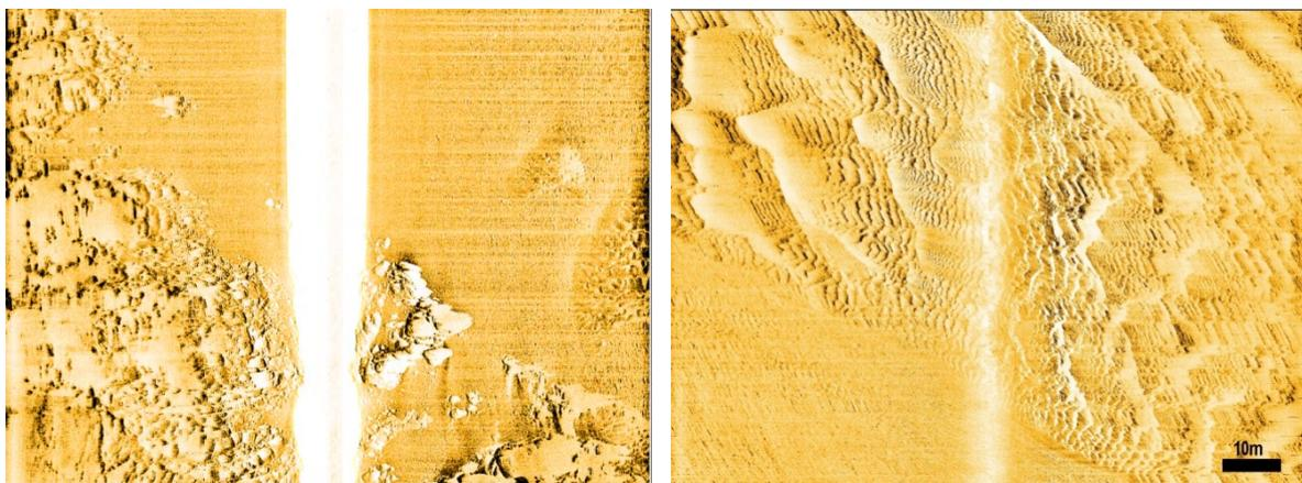
**Figura 11: Exemplos de imagens do sonar de varredura lateral mostrando: à esquerda, mostra contato entre afloramento rochoso e sedimentos; à direita, contato entre cascalhos (área sem estruturas sedimentares) e sedimentos arenosos. Registros obtidos no rio Araguaia em projeto financiado pela Finep – Financiadora de Estudos e Projetos (Processo 1780/06).**
