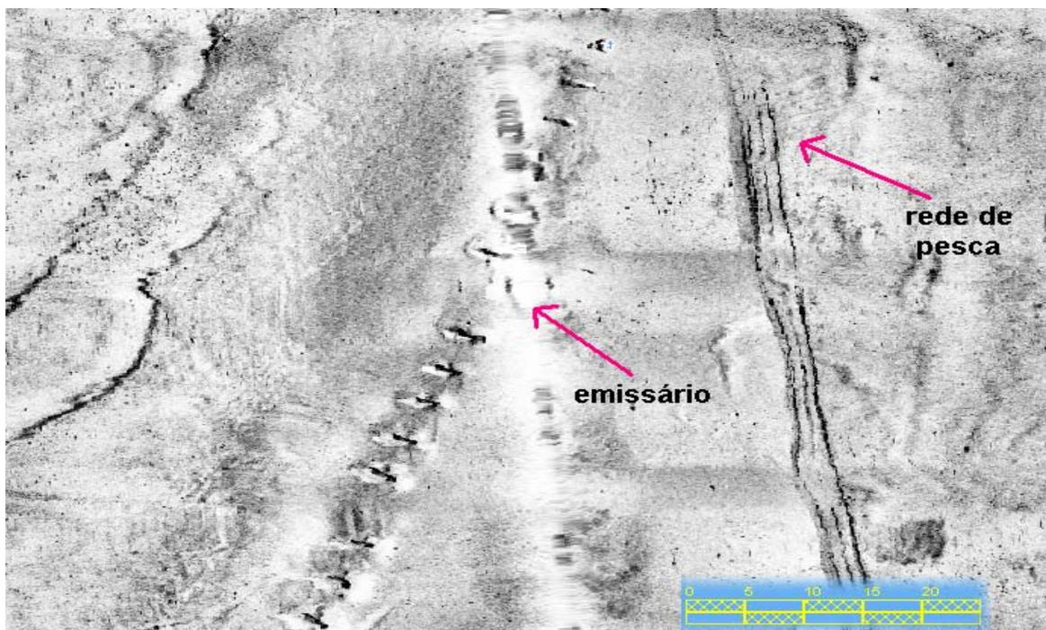
**Figura 21:** Imagem do sonar de varredura lateral Klein 3000 (100/500 kHz) mostrando o emissário submarino da Praia Grande, SP parcialmente enterrado, já que se observam apenas as estruturas de suporte do mesmo, distanciadas de cerca de 5m uma da outra. Fonte IPT/ASA, 2011.
