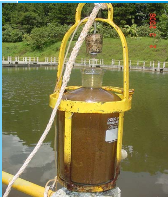
Coletor de fundo para amostragem do lodo da ETA Alto-Cotia
