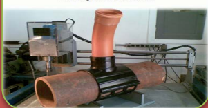
Acima, integrantes do TDT avaliam o selim regulável. Abaixo, o selim aplicado em tubulação de cerâmica
