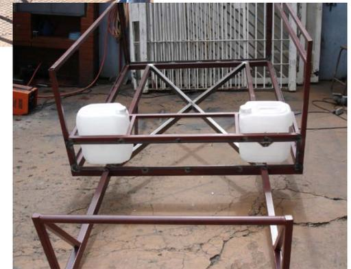
A estrutura principal do carrinho contém 2 vigas (3m cada), paralelas, que vão sofrer a carga distribuída ao longo de seu comprimento. São 600kg de material coletado, divididos pelas 2 vigas. Mas como é difícil a colocação das cargas em cima das vigas, com simetria, foi adotado um valor de 1.5 ao invés de 2.0, que seria o caso da carga ser colocada simetricamente sobre as vigas. Isso aumenta o fator de segurança em 30%.
