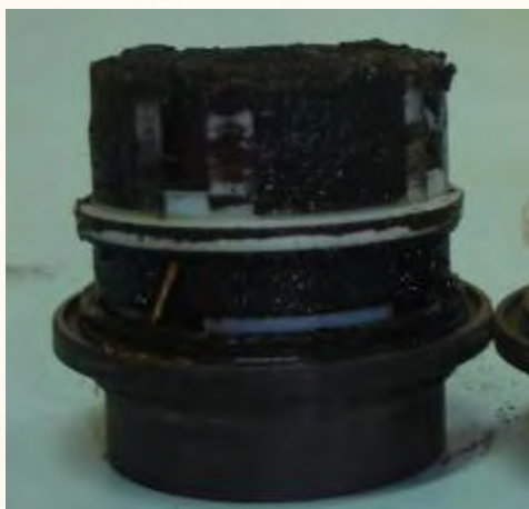
Fig. 18 – Hidrômetro comprometido com Mn.
