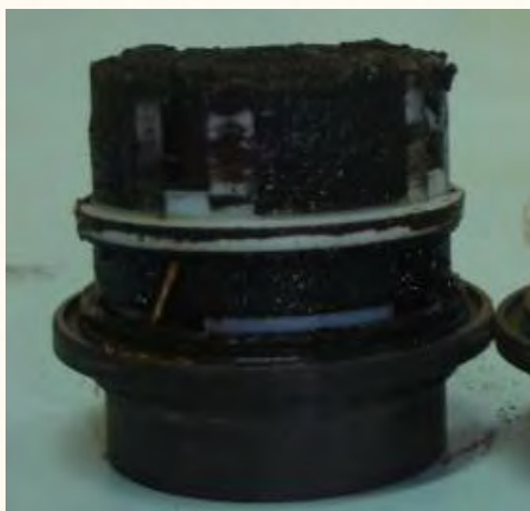
Fig. 04 – Engrenagens de hidrômetro obstruídas pelo Mn.
