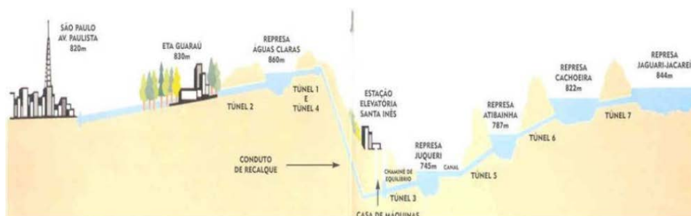
Perfil esquemático do Sistema Cantareira
