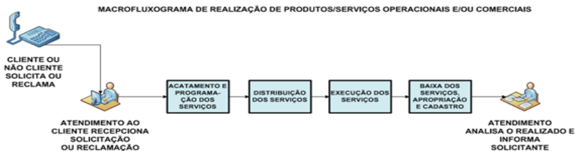
Figura 1 – Macrofluxograma da atividade de manutenção de rede de água e de esgoto
