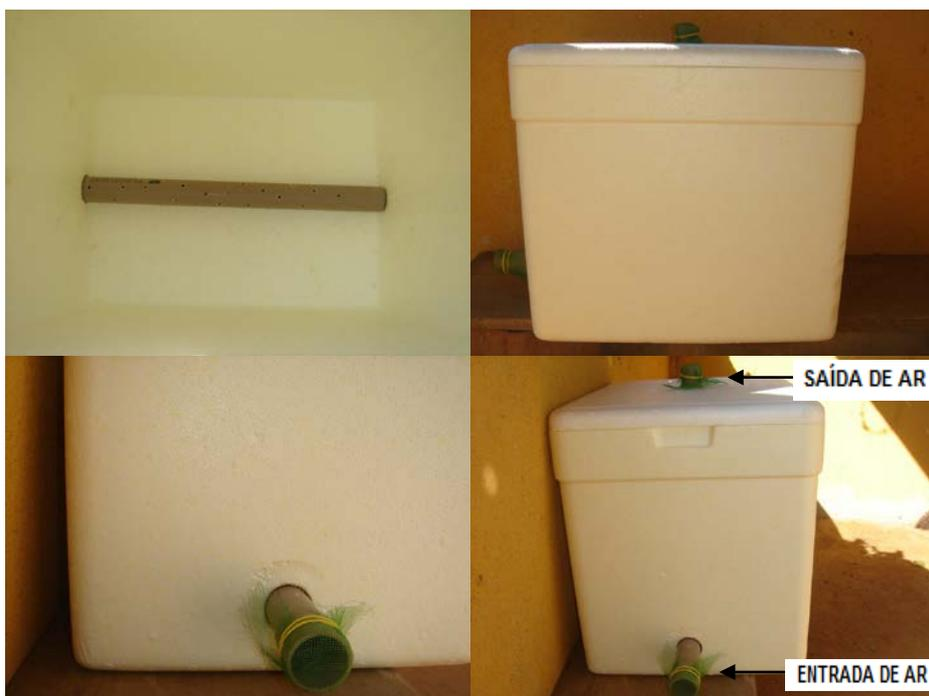
**Figura 2: Detalhes dos reatores de compostagem**
