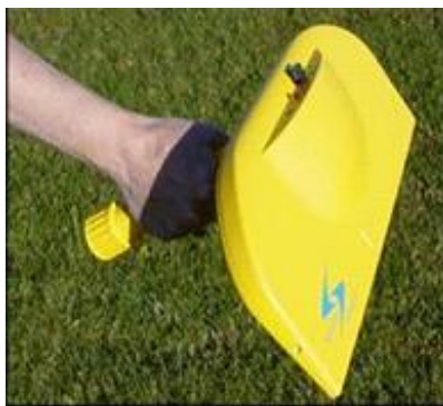
Foto 03: Locador de Tubulações
