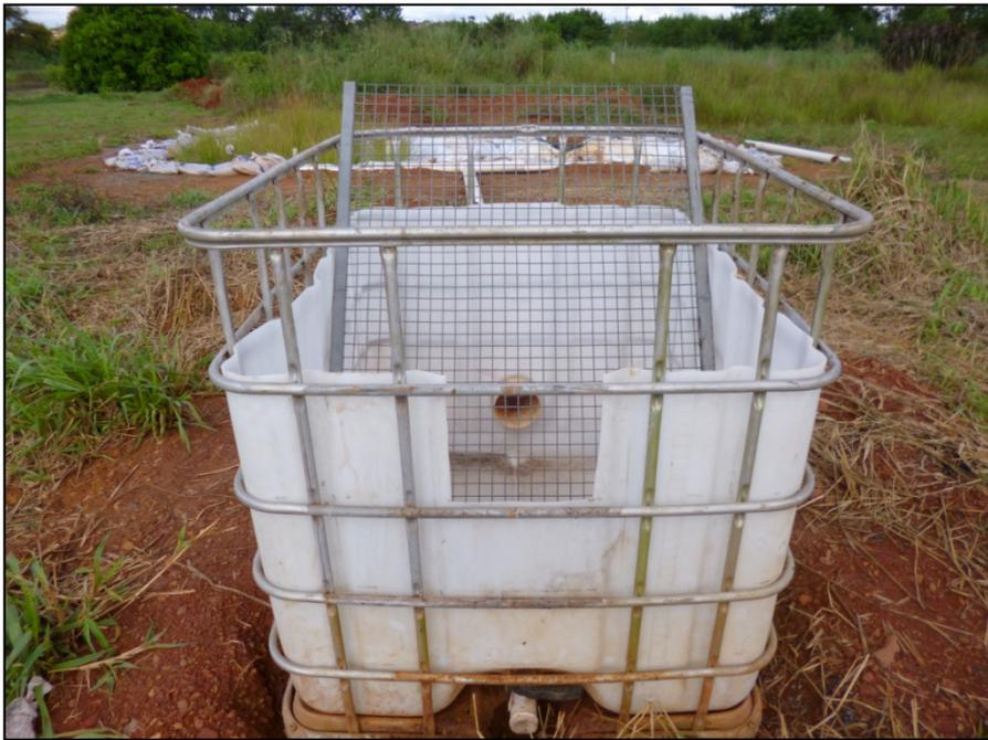
**Figura 17** – Caixa receptora com gradeamento
