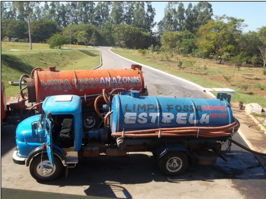
**Figura 2** – Imagem de um “caminhão Limpa-fossa” no processo de descarga do resíduo na ETE Goiânia.
