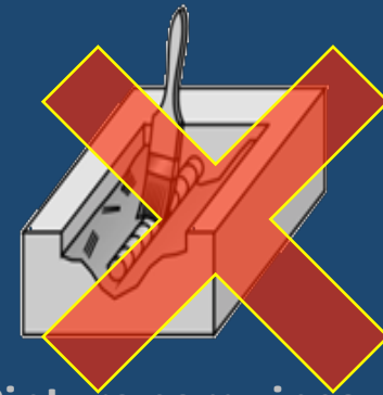
6. Pintura com zinco de proteção da armadura
