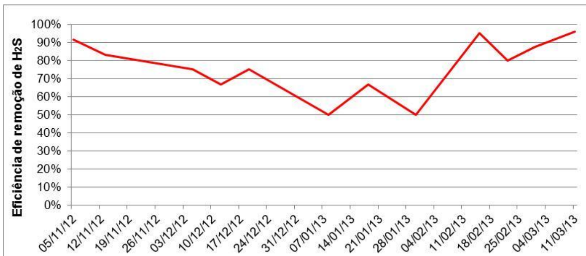
Figura 8 – Resultados do monitoramento da eficiência de remoção de H 2 S pelo biofiltro.
