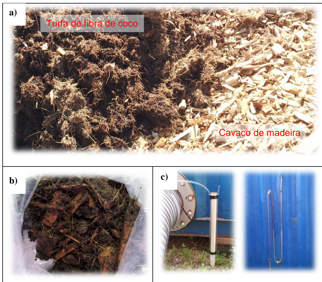
Figura 3 – a) Materiais que constituem a camada superior do biofiltro (antes da mistura e inseridos no contêiner); b) Amostra do meio suporte (mistura de turfa de coco e cavaco de madeira) coletada durante a operação; e c) Manômetros em ‘U’ da tubulação de recalque e após o meio filtrante.
