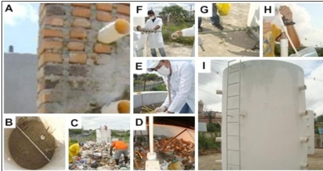
**Figura 3 – Etapas de construção (A), instrumentação (B), enchimento (C, D) e coleta e monitoramento do lisímetro (E, F, G, H, I).**
