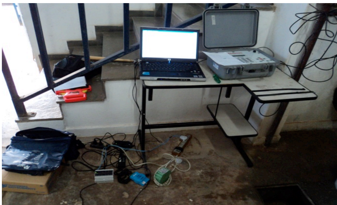
Figura 3 - Medidor de vazão ultrassom e sistema de aquisição de dados em Cruzeiro.
