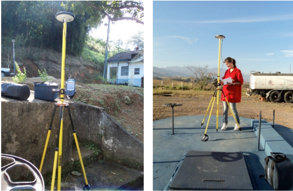
Figura 4 - Instalação do DGPS base e móvel.
