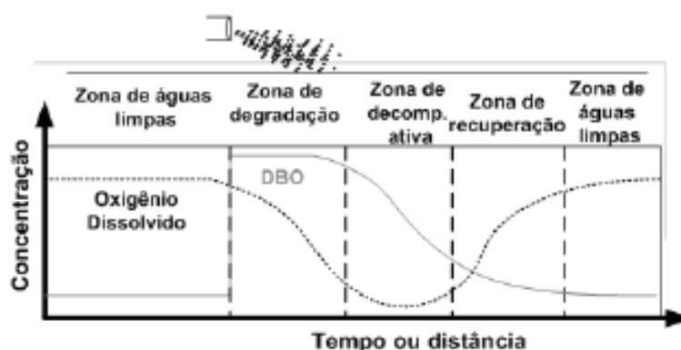
Figura 1 – Principais zonas de auto-depuração e sua relação com os valores de OD e DBO a cada etapa (adaptado de ANDRADE, 2010)
