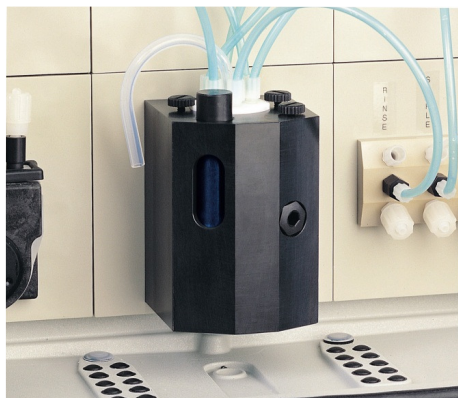
Figura 3 – Cubeta fotométrica de medição
