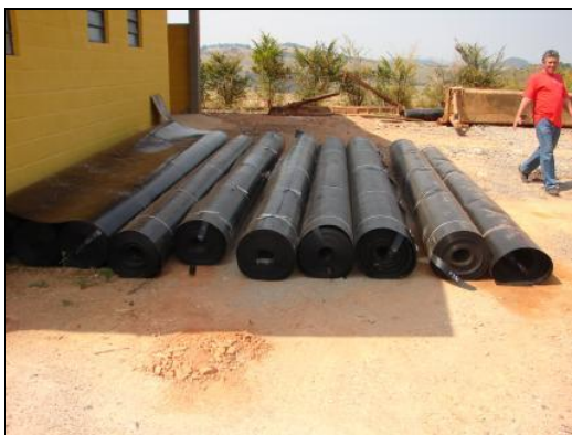
Figura 22 ó Vista geral das bobinas de manta de PEAD, sendo que cada bobina possui 295 m 2 .
