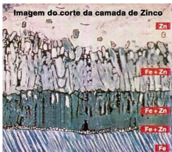
Figura 1 – Esquema Típico de um Revestimento Galvanizado por Imersão a Quente (ref. 3)
