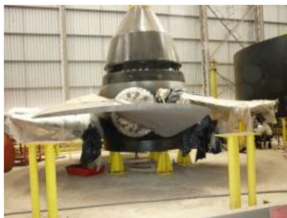
Figura 4 – Vista das pás de uma turbina tipo bulbo Usina Hidrelétrica de Santo Antônio. Fonte: Arquivo próprio.
