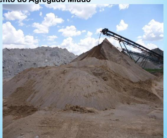
Constatação imediata: A linha de produção de processamento e reciclagem de resíduos, com capacidade de produzir até 80 toneladas de agregados por hora possibilita o descarte adequado de resíduos da construção civil, contribuindo com a preservação do meio ambiente, evitando depósitos em locais inadequados e contribuindo para que um grande volume de areia e pedra não seja extraído da natureza, evitando a degradação do meio ambiente.
