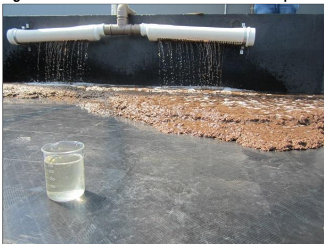
Figura 2 – Processo de descarte de lodo com polímero com destaque a água drenada obtida.
