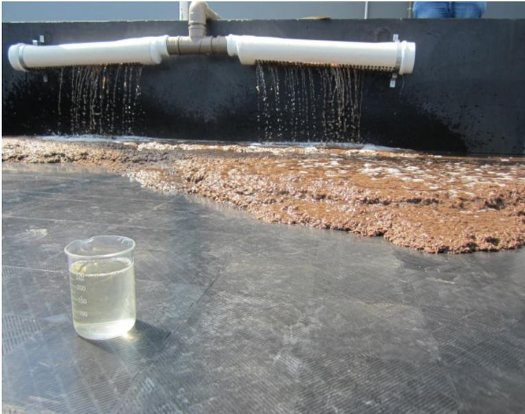
Figura 10: Lodo no momento do descarte e clarificado após a drenagem pelos blocos drenantes.
