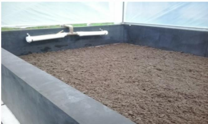
Figura 6: Torta de lodo após 24 horas do descarte.
