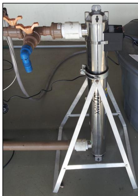
**Figura 5: Reator UV utilizado no teste piloto.**
