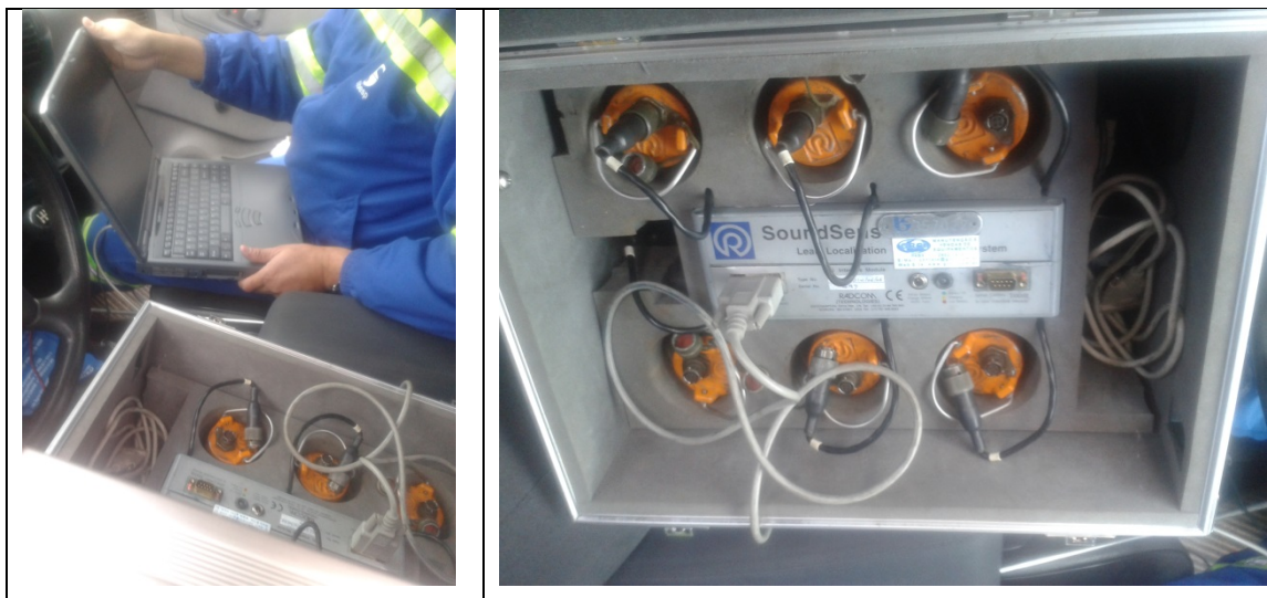
Figura 2. Equipamento correlacionador de ruídos utilizado.
