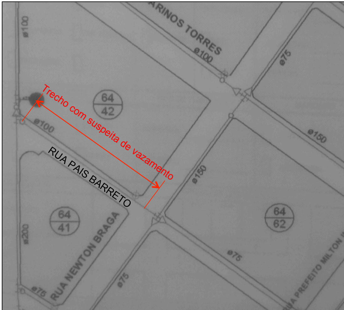
Figura 3: Planta utilizada em campo com cadastro técnico do SIGNOS da área com suspeita de vazamento em 29/05/2013 na Rua Pais Barreto.
