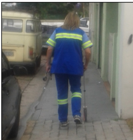
Figura 6: Medição da extensão da rede no trecho suspeito utilizando roda de medição.
