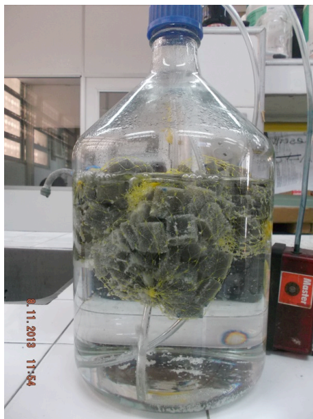
Figura 2 – Reator em batelada sequencial com biomassa imobilizada de Aspergillus niger AN 400
