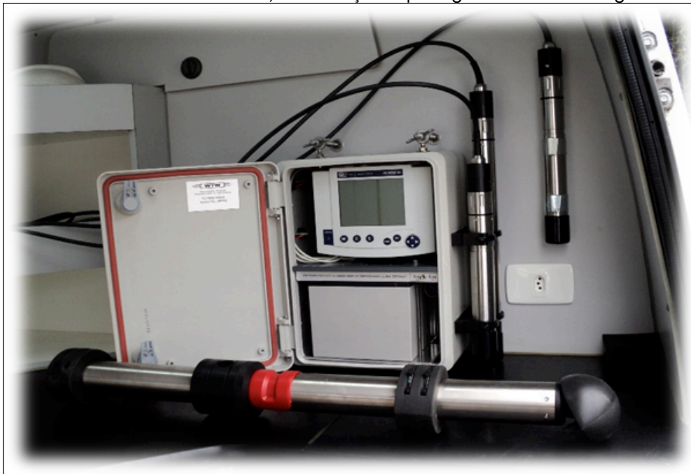
Figura 2: Equipamento Multiparamétrico de medição acoplado a UDM.
