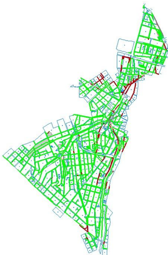
Figura 2 - Detalhe do resultado de cenário simulado demonstrando os trechos de redes e coletores com capacidade das redes comprometidas (em vermelho).
