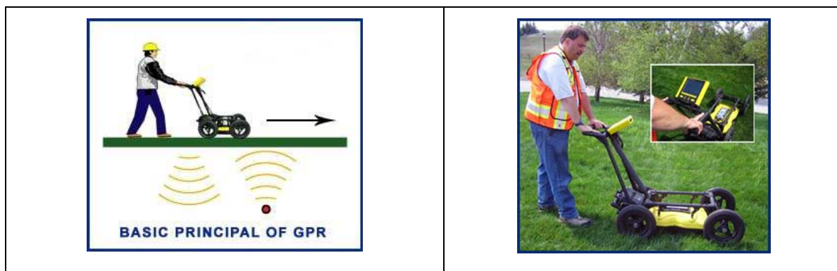
Figura 30: Radar de Penetração no Solo - GPR
