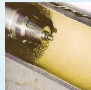
*O processo consiste na remoção das incrustações e aspersão do material de revestimento na parede da tubulação.*
