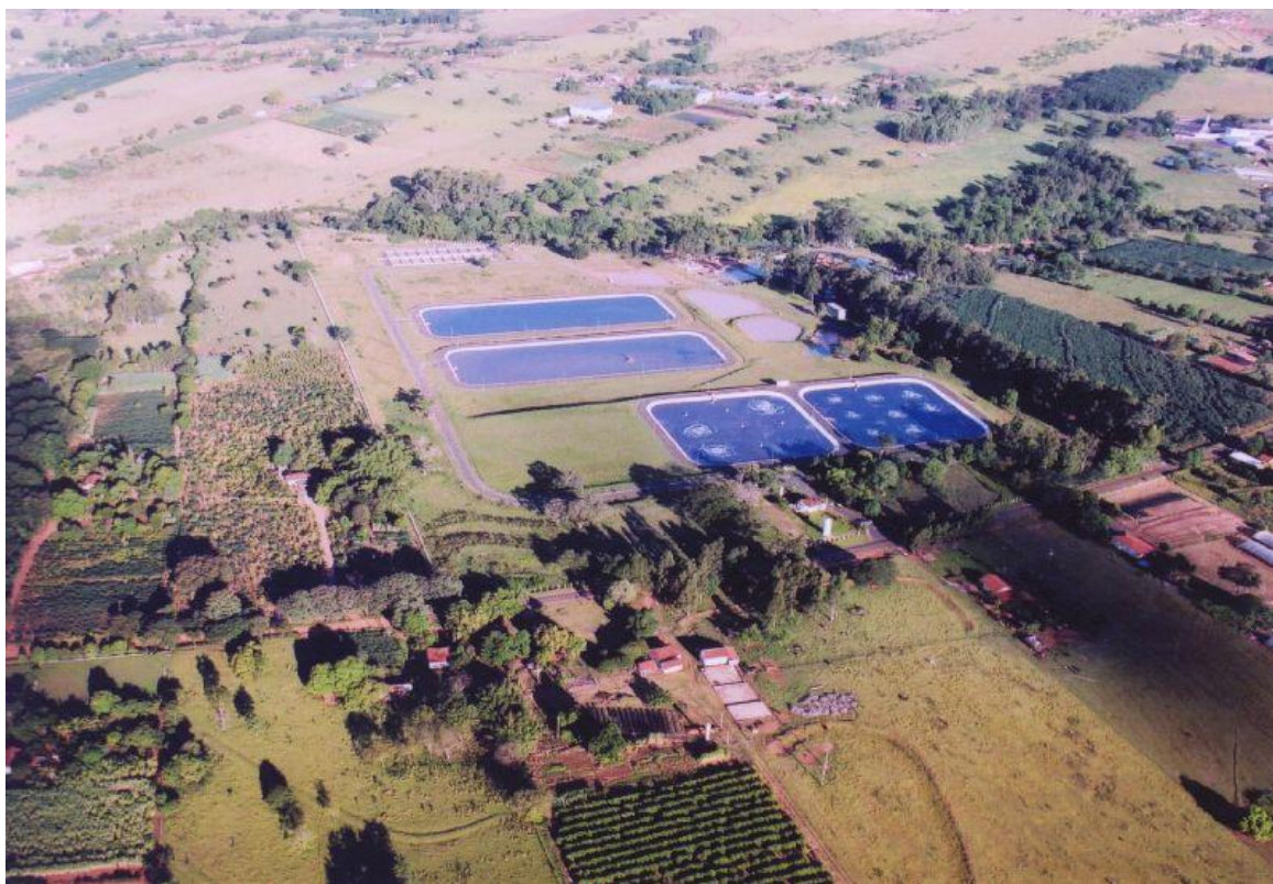
Figura 02. Foto ilustrando as Lagoas Aeradas seguidas de Sedimentação da ETE - Tupã
