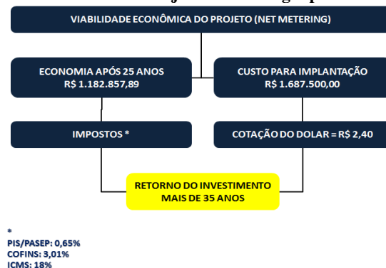
Figura 32 – Resumo da viabilidade econômica injetando a energia produzida na rede da concessionária
