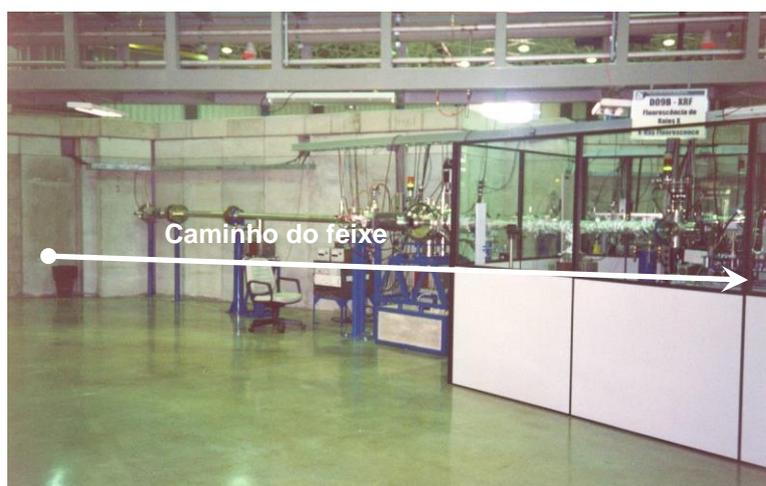
**Figura 2:** Foto da tubulação do anel para a linha D09B – XRF do Laboratório Nacional de Luz Síncrotron.
