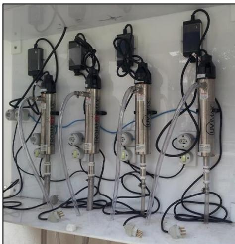
**Figura 2: Painel com reatores UV utilizados nos testes.**
