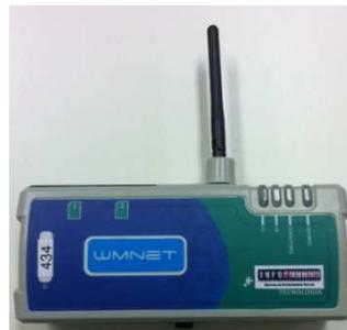
Figura 13 - Equipamento de Telemedicação GPRS
