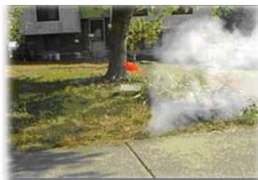
Figura 4: Fumaça subindo de um defeito em uma linha lateral. Fonte: GRIFFITH et al. (2013).
