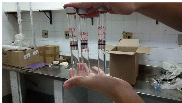
**Figura 08. Amostras Prontas para Análise Cromatográfica.**
