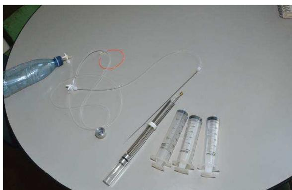
**Figura 03. Kit de Amostragem e Transferência de 'Headspace'.**
