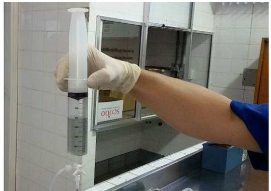
**Figura 06 (a, b). Fase de Repouso para Equilíbrio da Fração Gasosa de Metano com a Fração Dissolvida de Metano na Amostra.**
