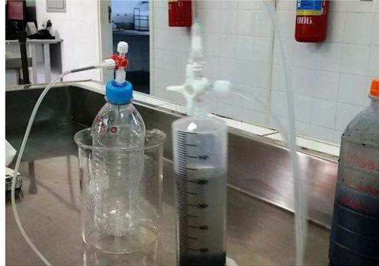
**Figura 04. Procedimento de Coleta da Amostra e Gás Argônio.**
