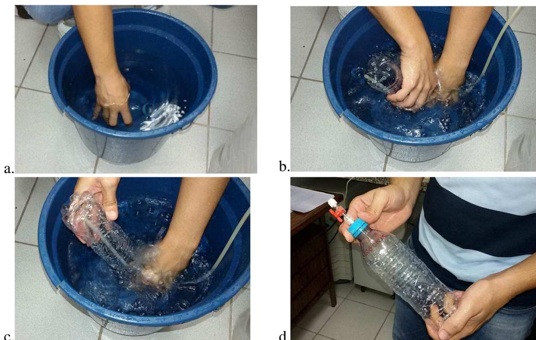
Figura 01 (a, b, c, d). Procedimento de Coleta do Gás de Arraste: Gás Argônio.
